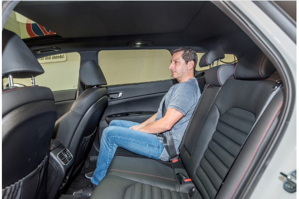
Für die Sicherheit: Kopfstütze auf Scheitelhöhe eingestellt und straff am Körper anliegende Gurten.
